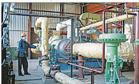
Новый компрессор в цехе получения хлористого аммиака.
